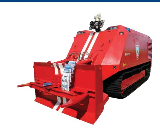
Многофункциональный автомобиль для проведения аварийно-спасательных работ и пожаротушения АБР-РОБОТ
