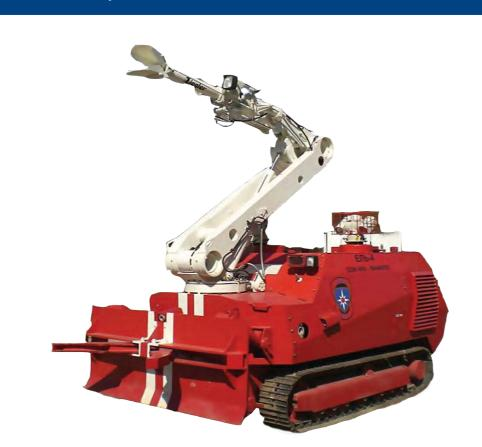
Многофункциональный робототехнический комплекс пожаротушения тяжелого класса ЕЛЬ-10
