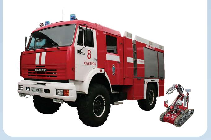
Пожарно-спасательный комплекс с роботизированной установкой газо-водяного тушения МПСК-РГВТ
