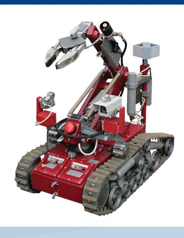
Многофункциональный робототехнический комплекс пожаротушения среднего класса ЕЛЬ-4
